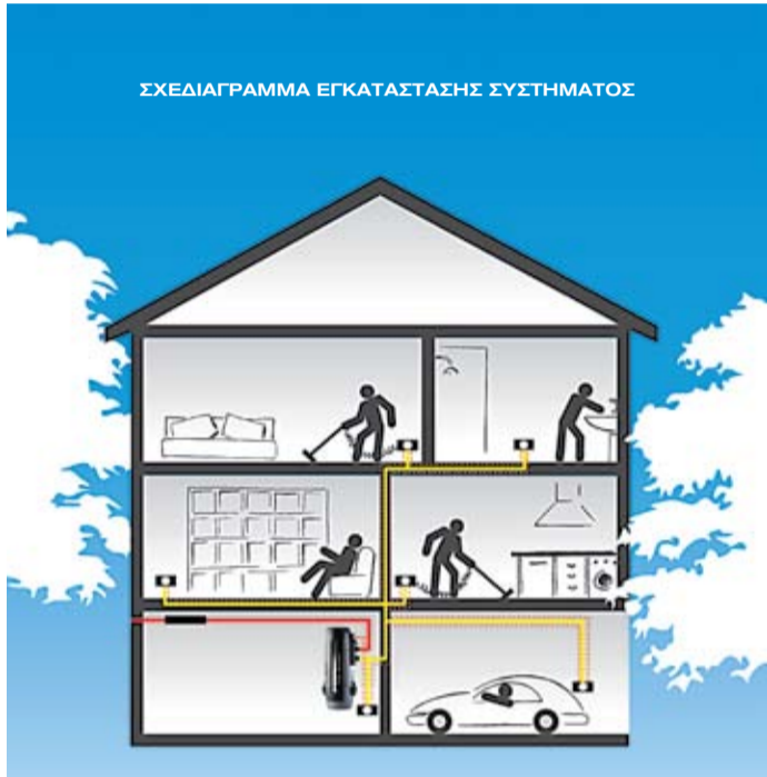
Η ΚΕΝΤΡΙΚΗ ΜΟΝΑΔΑ (ΜΟΤΕΡ & ΚΑΔΟΣ) ΤΟΠΟΘΕΤΟΥΝΤΑΙ ΣΕ ΔΕΥΤΕΡΕΥΟΝΤΑ ΧΩΡΟ
